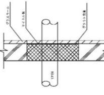
機械室送気管換気装置詳細図
