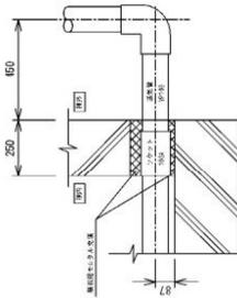
パイオ活性炭換気装置詳細図 (54箇所)
