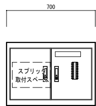
10P端子箱 参考姿図 屋外埋込型 SUS 製 指定色仕上 埋込深さは、120mm程度とする 鍵形状は、監督員と協議の上、決定すること
