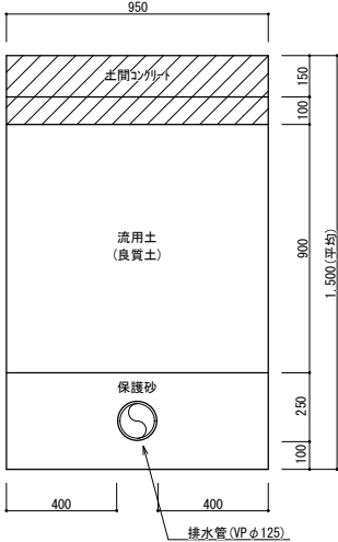
排水管布設断面図 (敷地内通路部)
