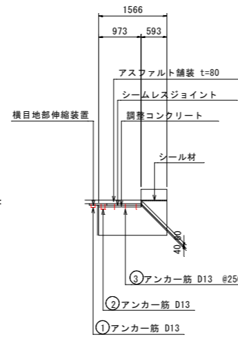
A1側 巻き込み部
