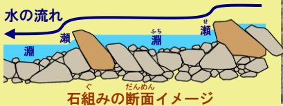
分散型落差工を使って川の多様な環境を再現 (岩岳川・福岡県豊前市)
